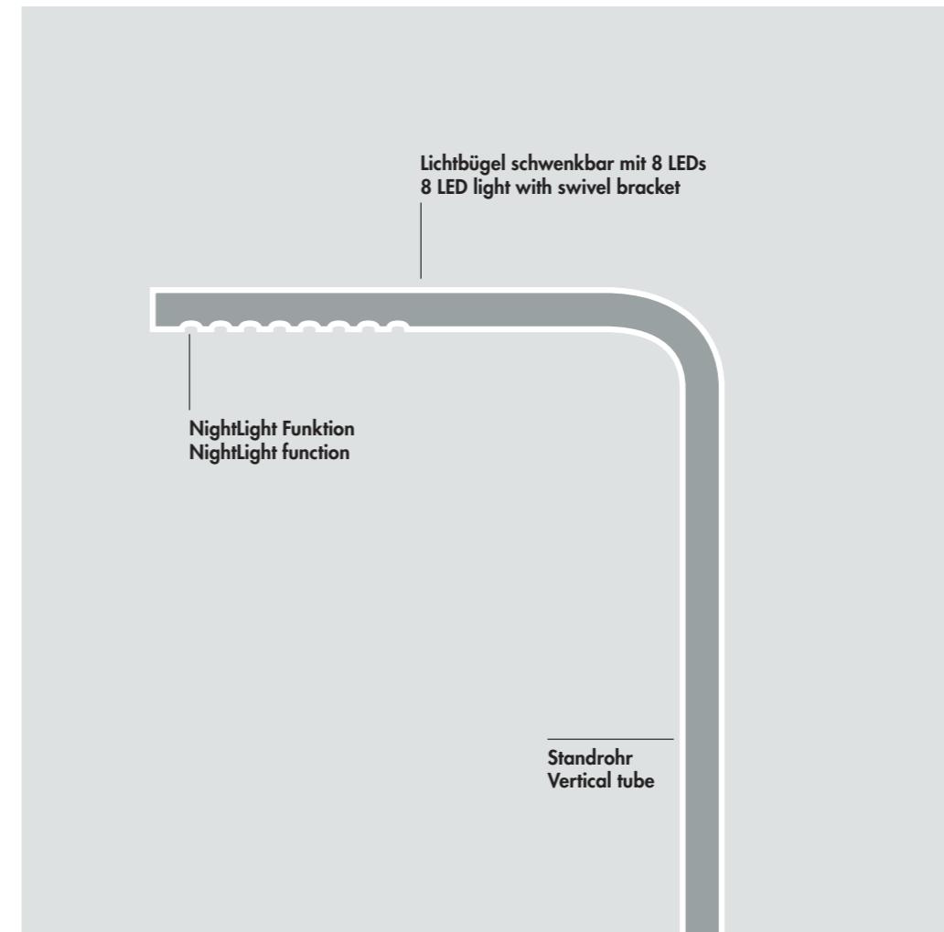
**Lichtbügel schwenkbar mit 8 LEDs**
